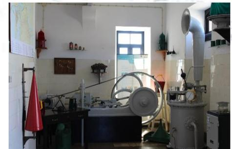
O ar comprimido faz vibrar a palheta e escapa-se pelo tubo acústico, produzindo um som. A válvula regula a saída do ar a fim de produzir o ritmo.
